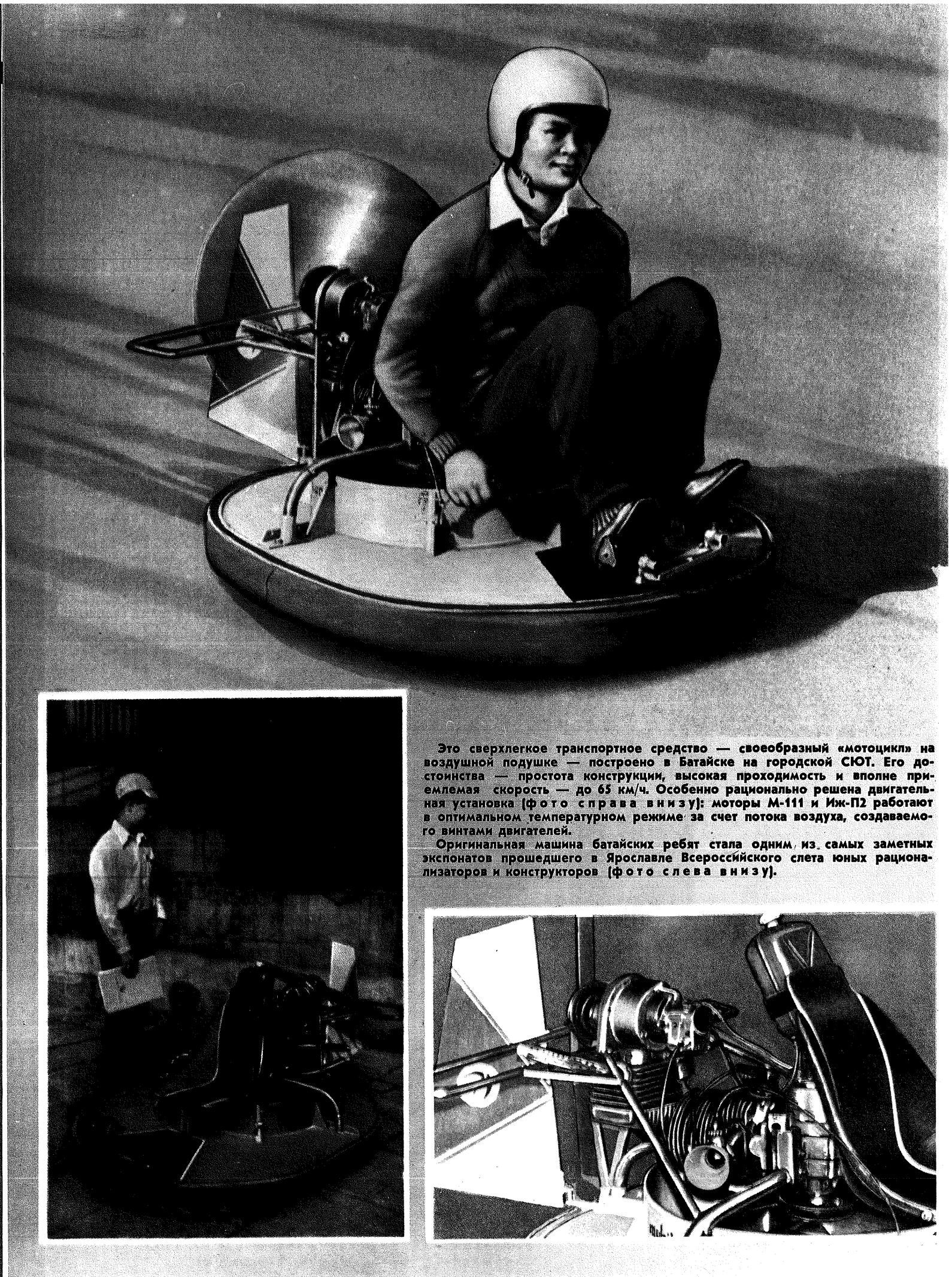
Это сверхлегкое транспортное средство — своеобразный «мотоцикл» на воздушной подушке — построено в Батайске на городской СЮТ. Его достоинства — простота конструкции, высокая проходимость и вполне приемлемая скорость — до 65 км/ч. Особенно рационально решена двигательная установка [фото справа внизу]: моторы М-111 и Иж-П2 работают в оптимальном температурном режиме за счет потока воздуха, создаваемого винтами двигателей.
